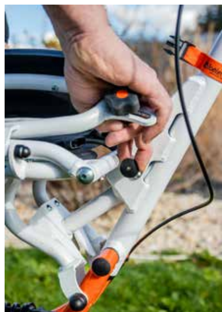
5. Basculer l'assise dans l'empreinte à l'arrière avec le doigt d'indexage tiré.
