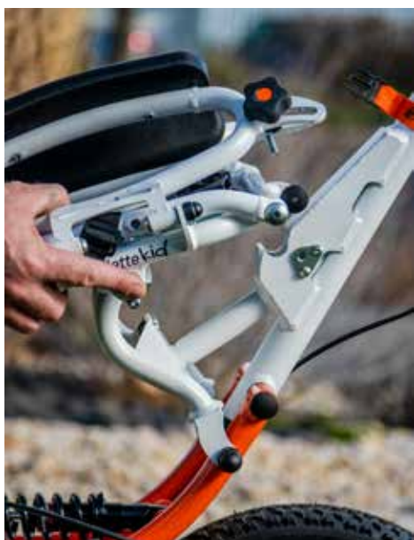
4. Placer l'assise dans les fourches du châssis prévues à cet effet.
