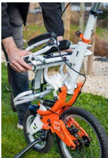
4. Placer l'assise dans les fourches du châssis prévues à cet effet.
