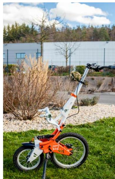
1. Despliega el soporte. Coloca el chasis sobre sus ruedas. Afloja la correa de la parte delantera, luego endereza el tallo hasta que oigas el «clic». Comprueba que el chasis está bloqueado.
