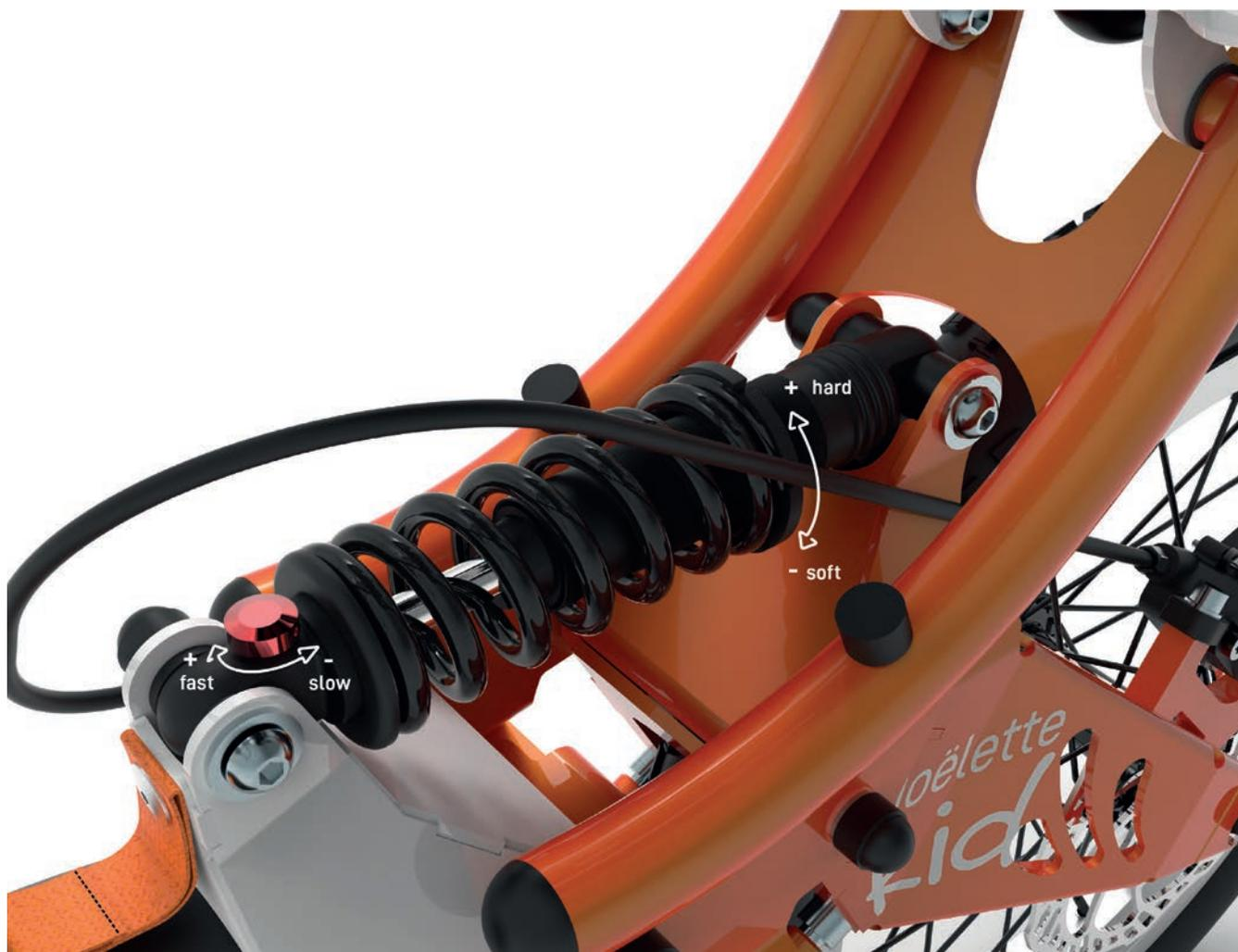
Puedes ajustar la dureza del amortiguador de tu Joëlette Kid gracias a la tuerca situada en la parte trasera del muelle, pero también su velocidad de rebote con el pomo situado en la parte delantera.
