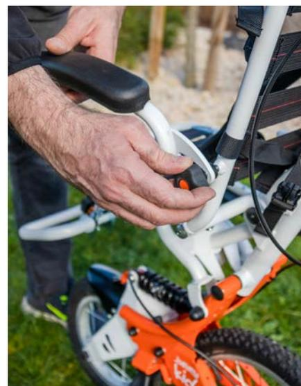
7. Levante los apoyabrazos y atorníllelos al respaldo con las perillas, ajustando su inclinación.
