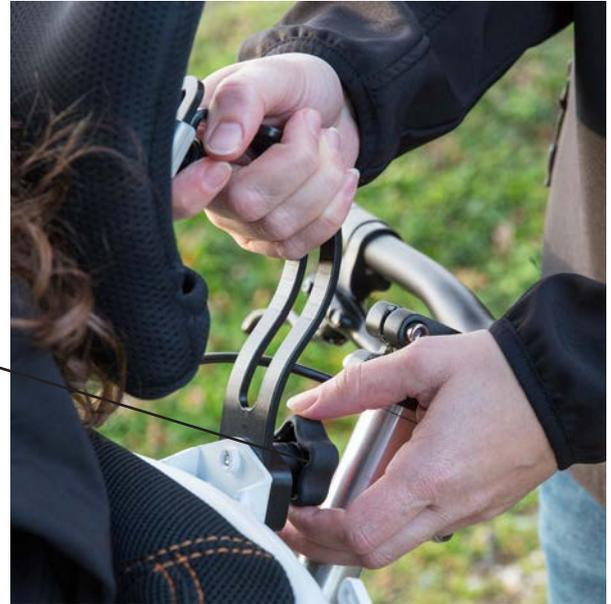
1. Inserte el soporte del reposacabezas entre el respaldo y la parte plástica y asegúrelo con la perilla
