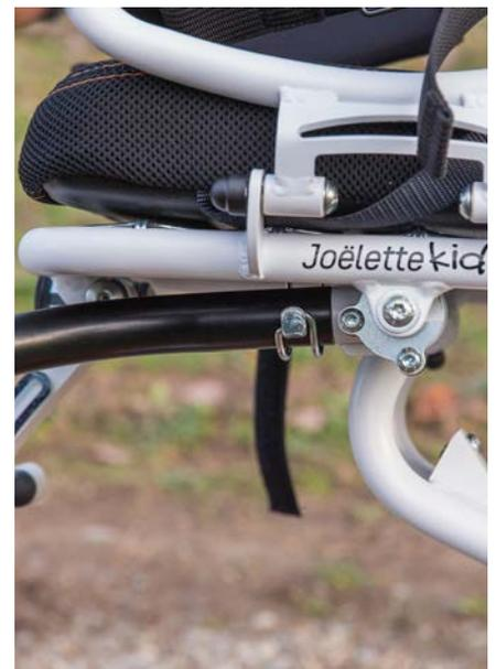
3. Inserte el imperdible y doble la parte metálica redondeada del tubo para asegurar el accesorio. Compruebe que los brazos están bien sujetos.
