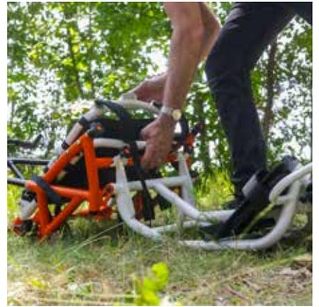
**6.** Faire basculer le repose-pieds vers l'avant jusqu'à la butée (prendre garde au coincement de doigts / main).
