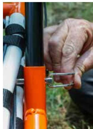
**3.** Retirer les deux goupilles de sécurité. Puis, insérer les deux branches du guidon dans les logements du châssis prévus à cet effet. Enfin, remettre les goupilles de sécurité.
