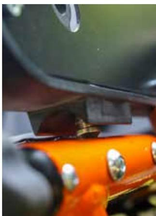
**11.** Introduire l'avant de l'accoudoir dans le châssis.
