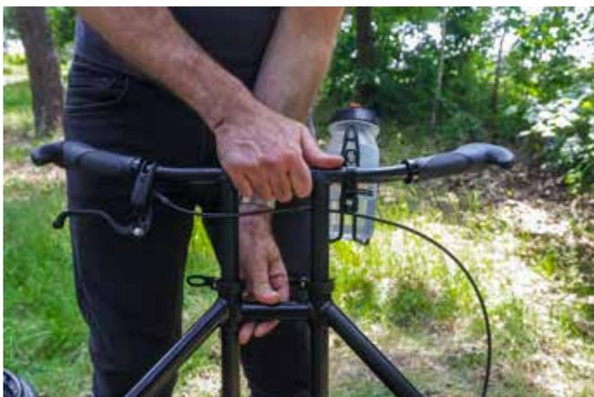
**4.** Lösen Sie die Schnellspannhebel am Lenker, um ihn auf die richtige Höhe einzustellen.
