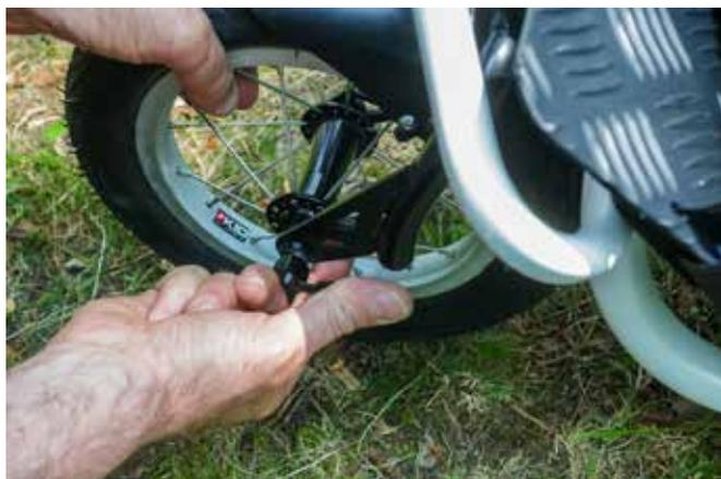
**17.** Dann mit dem Schnellspannhebel anziehen.
