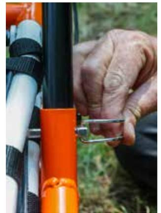
**3.** Entfernen Sie die beiden Sicherungstifte. Stecken Sie dann die beiden Lenkerstreben in die dafür vorgesehenen Rahmenaufnahmen. Schließlich die Sicherungstifte wieder einsetzen.
