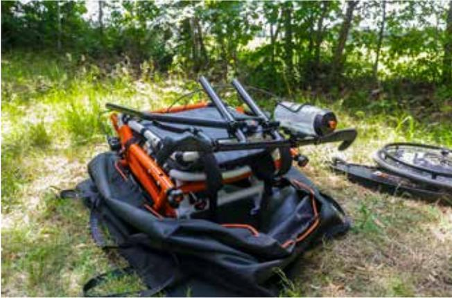
**1.** Der Joëlette Finisher aus der Tragetasche (optional) nehmen und auf den Boden stellen. Der Lenker muss nach oben positioniert werden.
