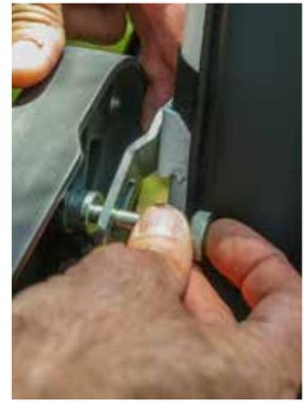
**14.** Diese Achsen in den Rückenblechen abgleichen und dann in den Schnellspannhebel einschrauben.
