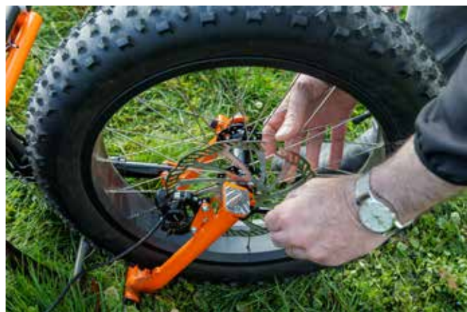
7. Positionner la roue entre les fourches du bras oscillant et l'immobiliser avec le blocage rapide
