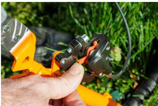
6. Retirer la cale en plastique positionnée entre les plaquettes.
