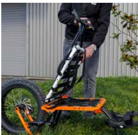
8. Déplier le dossier et baisser le guidon, grâce à la poignée à gauche, pour le reposer sur la roue.
