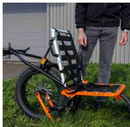
8. Déplier le dossier et baisser le guidon, grâce à la poignée à gauche, pour le reposer sur la roue.
