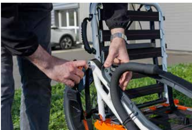
9. Installer les deux bras avant avec les vis de fixation latérales.
