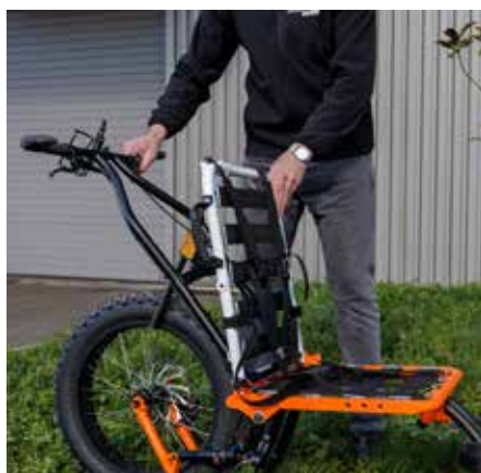
8. Déplier le dossier et baisser le guidon, grâce à la poignée à gauche, pour le reposer sur la roue.
