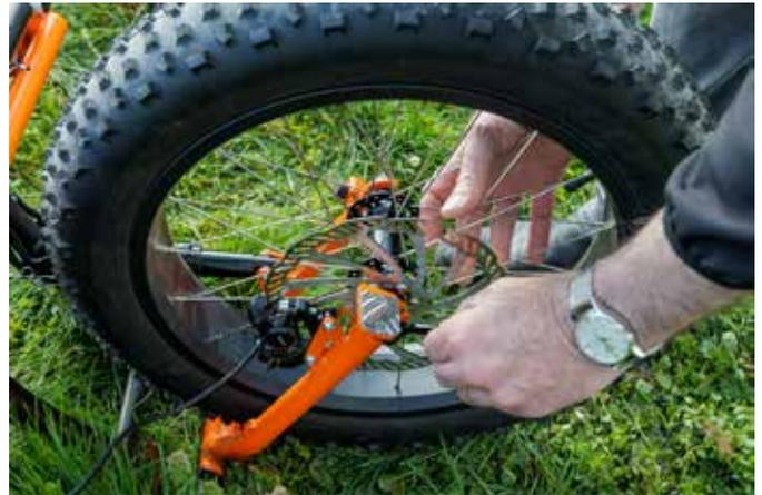
**7.** Coloque la rueda entre las horquillas del basculante y fíjela con el cierre rápido
