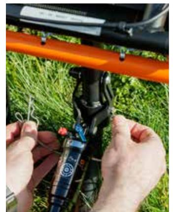
**4.** Retire el pasador y el pasador beta e incline el basculante de modo que los orificios del soporte de montaje del amortiguador coincidan con los del bastidor de transferencia.
