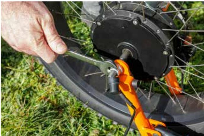
**4.** Sapríete las tuercas (llave fija o de estrella de 18 mm). El par de apriete debe ser suficiente (50 Nm).
