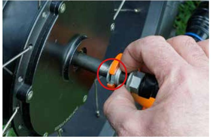
**3.** Coloque las dos arandelas del pasador en contacto con el exterior de la horquilla con el pasador insertado en **la parte delantera de la ranura**.
