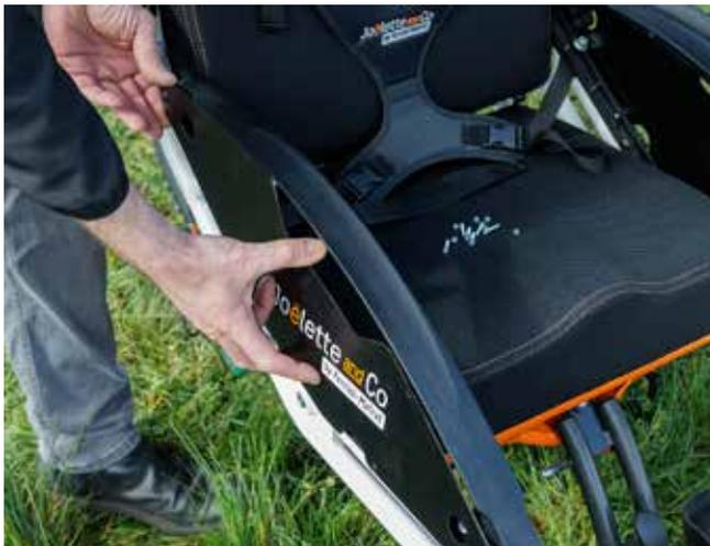
**1.** Coloque la placa en la parte exterior del reposabrazos.
