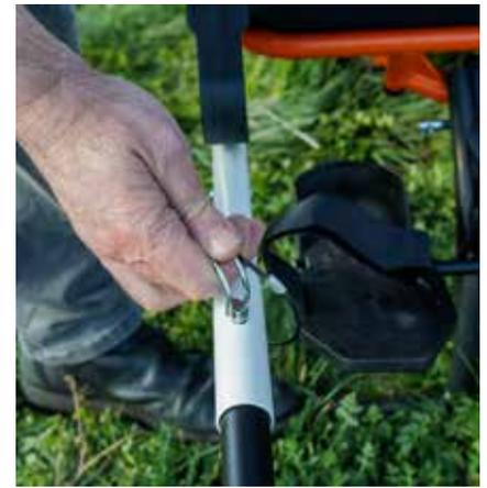
**14.** Arme mit dem Sicherungstift verriegeln
