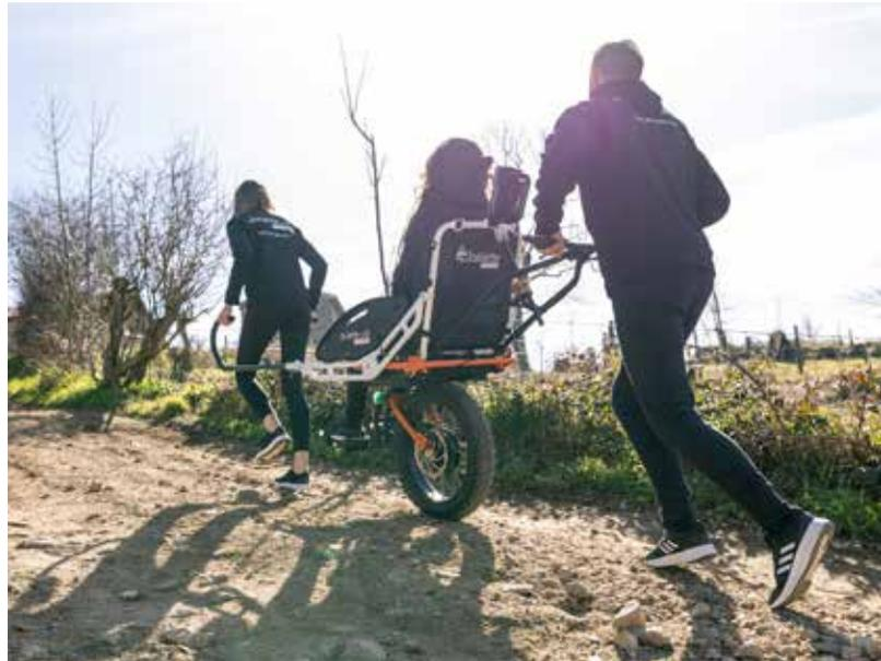
Wenn er beim Ziehen hilft, indem er sich seitlich auf Höhe des Passagiers positioniert und der Joëlette an den Armlehnen oder an den Seitengriffen (Option) zieht, muss er darauf achten, dass seine Zugkraft in die gleiche Richtung wie die des vorderen Fahrers gerichtet ist und dass er das vom hinteren Fahrer vorgegebene Gleichgewicht nicht destabilisiert.
