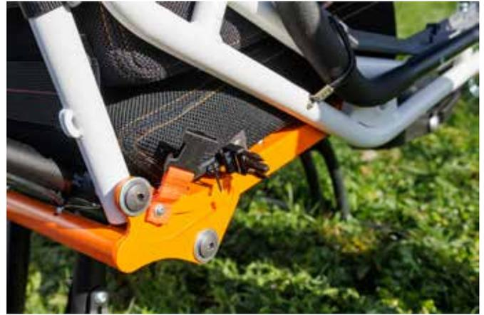
**12.** Lassen Sie die seitlichen Schnallen, die an der Sitzfläche angenäht sind, einrasten und klappen Sie den Brustpanzer nach vorne.
