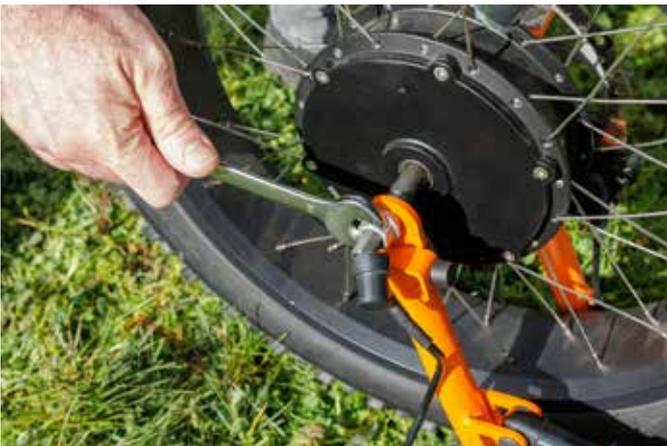
**4. Ziehen Sie die Muttern fest ( 18er Maul- oder Ringschlüssel). Das Anzugsmoment muss ausreichend sein (50Nm).**
