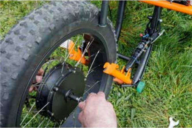
**2. Setzen Sie das Rad in die Nuten der Gabel ein (Scheibe links). Das Stromkabel muss zur Vorderseite der Joëlette zeigen.**
