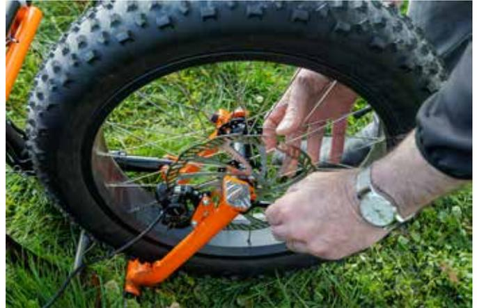
**7.** Positionieren Sie das Rad zwischen den Gabeln der Schwinge und sichern Sie es mit dem Schnellspanner.
