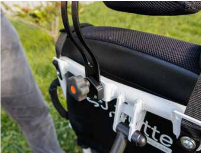
**3.** Schieben Sie die Kopfstütze in den Sitz auf der Rückseite der Rückenlehne.
