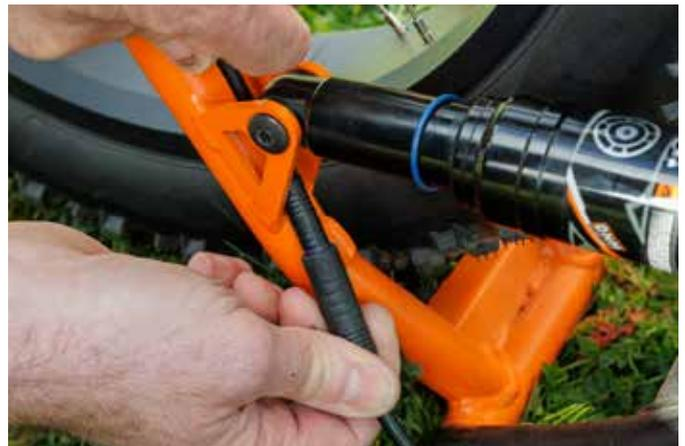
**5. Stecken Sie das Stromkabel des Motors ein. Achten Sie darauf, dass die Pfeile auf den beiden Steckern übereinstimmen.**
