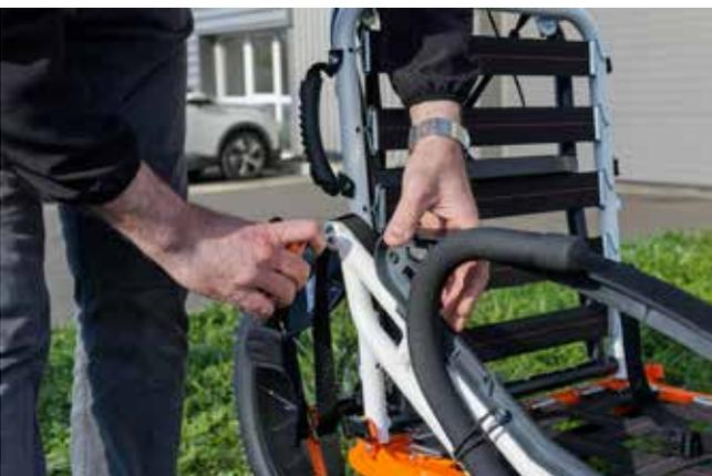
**9.** Installieren Sie die beiden vorderen Arme mit den seitlichen Befestigungsschrauben.
