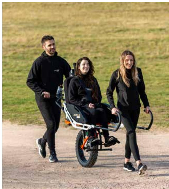
Sobald der Gleichgewichtspunkt gefunden ist, nutzt der hintere Fahrer das Verstellsystem des hinteren Lenkers, um die Griffe auf Höhe seines Beckens zu haben:
