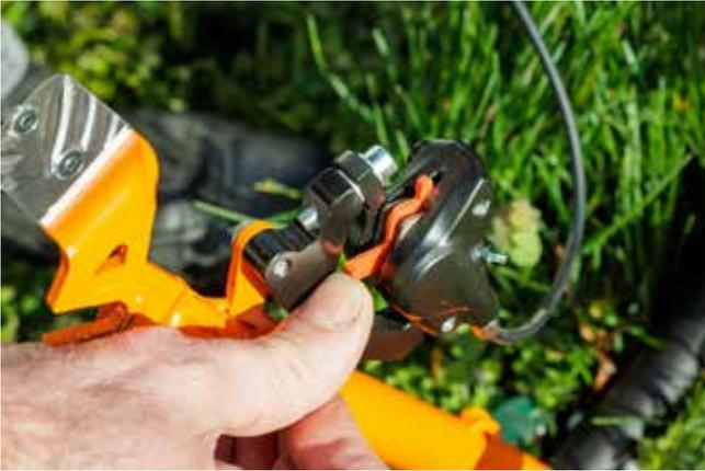
**6.** Entfernen Sie den Plastikkeil, der zwischen den Plättchen positioniert ist.
