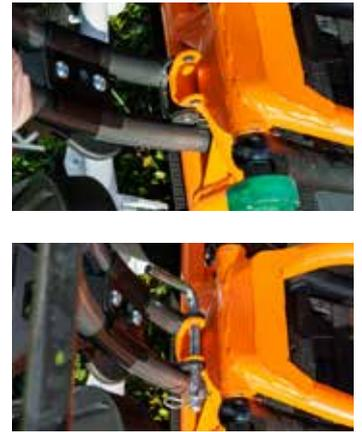
**2.** Nehmen Sie die Fußstütze, die sich in der Mitte der Schwinge befindet. Schwingen Sie sie in ihrer Halterung und verriegeln Sie sie mit dem Stift und dem Splint
