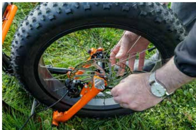
**7.** Posizionare la ruota tra le forcelle del forcellone e fissarla con il bloccaggio rapido.
