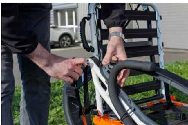
**9.** Installare i due bracci anteriori utilizzando le viti di fissaggio laterali.
