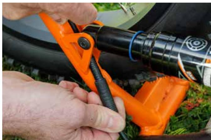
**5.** Collegare il cavo di alimentazione del motore. Accertarsi che le frecce sulle due prese coincidano.
