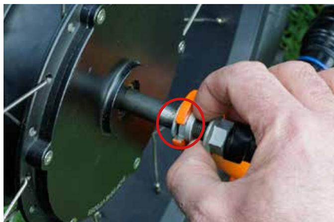
**3.** Posizionare le due rondelle del perno a contatto con l'esterno della forcella, con il perno inserito nella **parte anteriore della scanalatura**.
