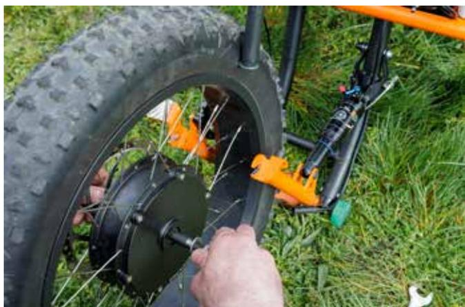
**2.** Inserire la ruota nelle scanalature della forcella (disco a sinistra). Il cavo di alimentazione deve essere diretto verso la parte anteriore della Joëlette.
