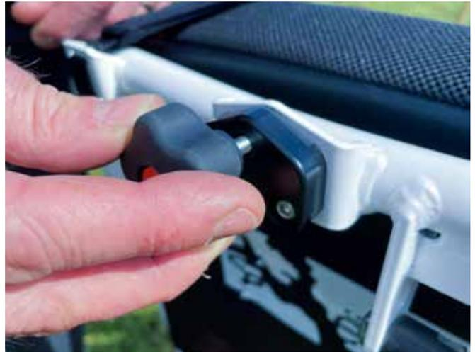
**1.** Fissare la flangia di plastica al retro dello schienale con le viti in dotazione.
