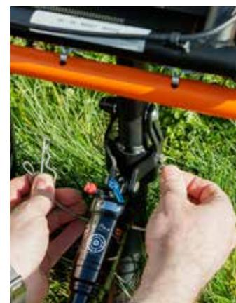
**4.** Rimuovere il perno e il perno beta e inclinare il forcellone in modo che i fori della staffa di montaggio dell'ammortizzatore inclinare il forcellone in modo che i fori della staffa di montaggio dell'ammortizzatore coincidano con quelli del telaio di trasferimento.
