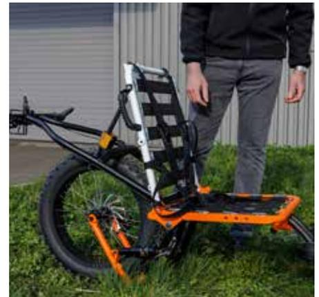
**8.** Despliegue el respaldo y baje el manillar, utilizando la empuñadura de la izquierda, para apoyarlo sobre la rueda.
