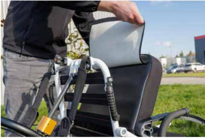
**11.** Pase la solapa del respaldo por detrás de las cintas elásticas y fíjela con la cinta de velcro.
