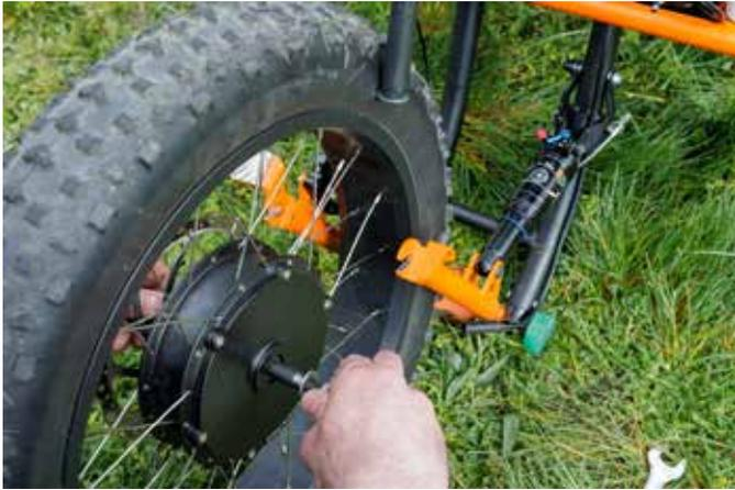
**2.** Introduzca la rueda en las ranuras de la horquilla (disco de la izquierda). El cable de alimentación debe orientarse hacia la parte delantera de la Joëlette.
