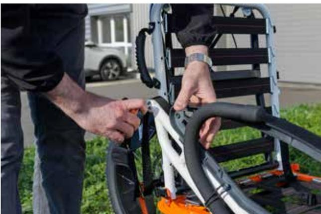
**9.** Instale los dos brazos delanteros con los tornillos de montaje laterales.
