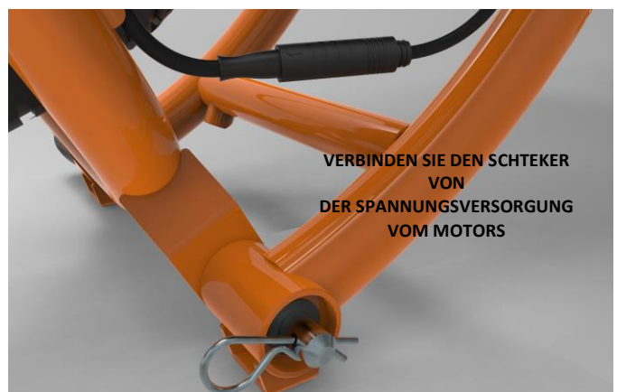
VERBINDEN SIE DAS KABEL VOM BESCHLEUNIGER ACHTEN SIE DARAUF, DASS DIE MIT ZEICHEN-WEIß AUSGERICHTET SEIN. GEHEN DIE KABEL ZWISCHEN STEIGROHR UND LENKER UND MIT DEM HALTER VOM AKKU ZU VERBINDEN
