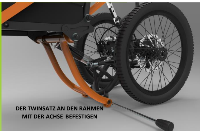
DEB STÖßDÄMPFER MITHILFE DER MITGELIEFERTEN SCHRAUBEN AN DAS TWINSET MONTIEREN
