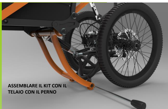
COLLEGARE L'AMMORTIZZATORE CON IL KIT UTILIZZANDO LA VITE E IL DADO FORNITI
