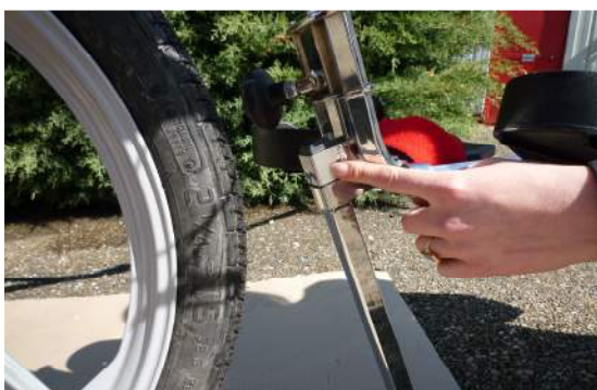
15. Vérifier le bon verrouillage du pied
