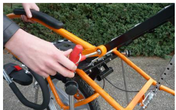
16. Engager le vis d'accouder sur le dossier avec la clé fournie
